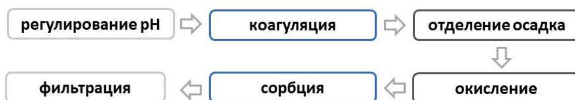
Рисунок. Схема последовательности стадий коагуляционно-адсорбционного способа очистки многокомпонентных сточных вод
