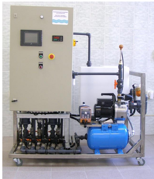
Пилотные установки низконапорной тупиковой ультрафильтрации
