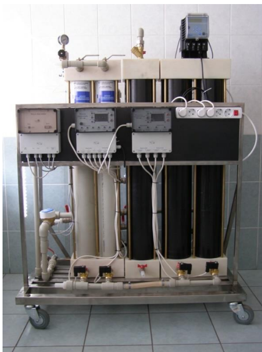
Пилотные установки низконапорной тупиковой ультрафильтрации
