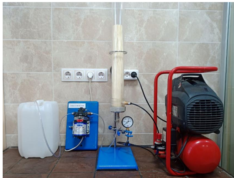
Рисунок 4. Лабораторная установка для тонкой очистки воды при помощи погружных ультрафильтрационных мембран
